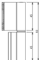
Петля двухсекционная предназначена для установки на алюминиевые поворотные и откидные створки с системой Европаз.
