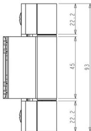
Петля двухсекционная предназначена для установки на алюминиевые поворотные и откидные створки с системой Европаз.
